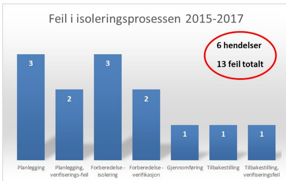
Figur 3.6 HC-lekkasjer i perioden 2015 – 2017 med isolering som umiddelbar omstendighet
