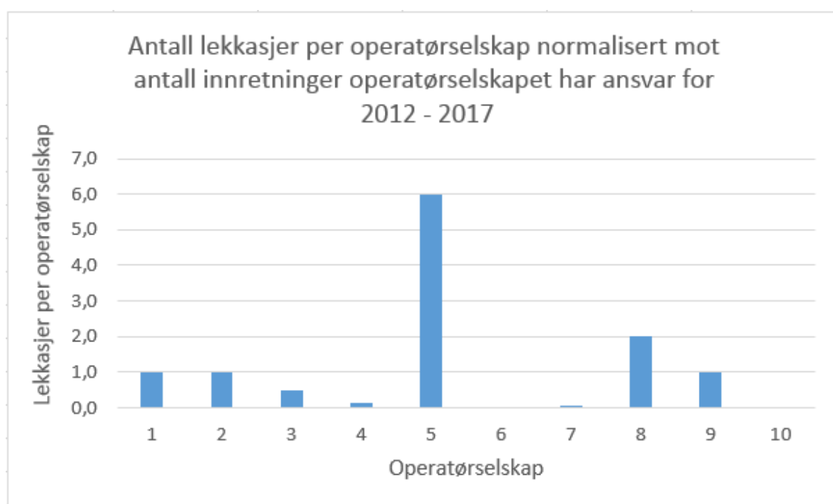
Figur 3.9 Antall HC-lekkasjer per operatørselskap
