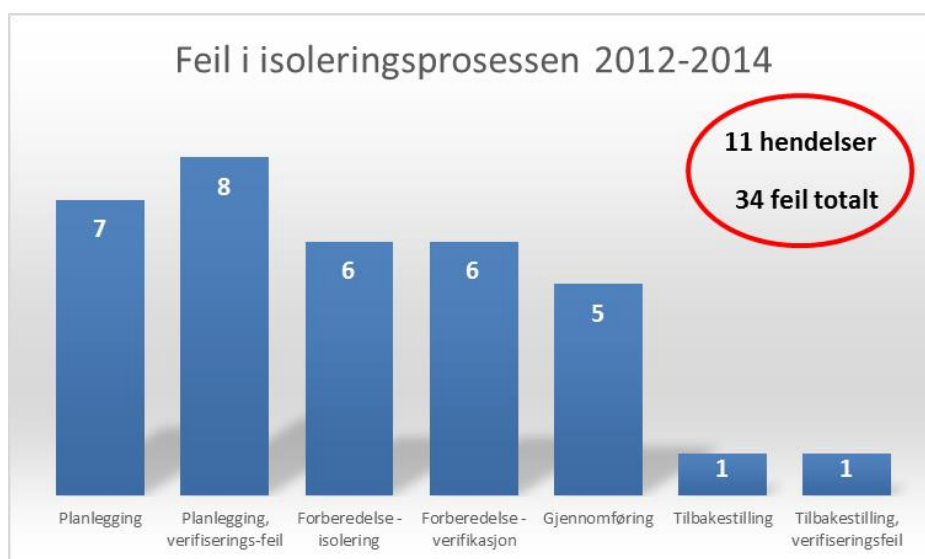
Figur 3.5 HC-lekkasjer i perioden 2012 – 2014 med isolering som umiddelbar omstendighet
